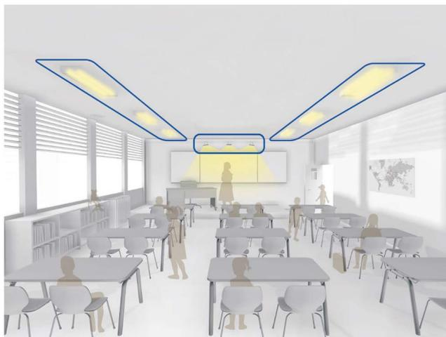
I rilevatori a 3 zone DALI LIGHT UP possono controllare 3 zone di illuminazione:
