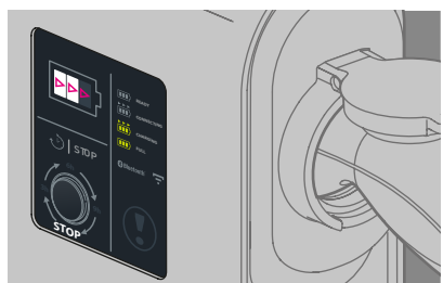
"Stazione collegata al veicolo" in attesa di ricarica (scorrimento bianco) (da 0 a 30" secondo i veicoli)
