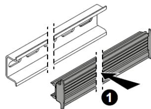
1. Fissare la guida comunicante sulla rotaia DIN
