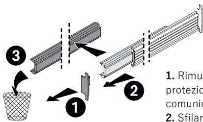
1. Rimuovere una delle due protezioni laterali della guida comunicante
