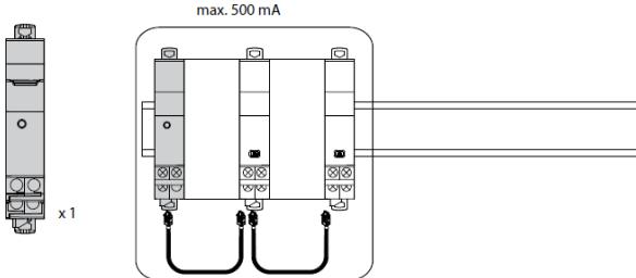
In questo caso è necessario separare i diversi gruppi di dispositivi tramite il cavo bianco di disaccoppiamento (fornito con il Modulo di alimentazione EMS BTDIN)
