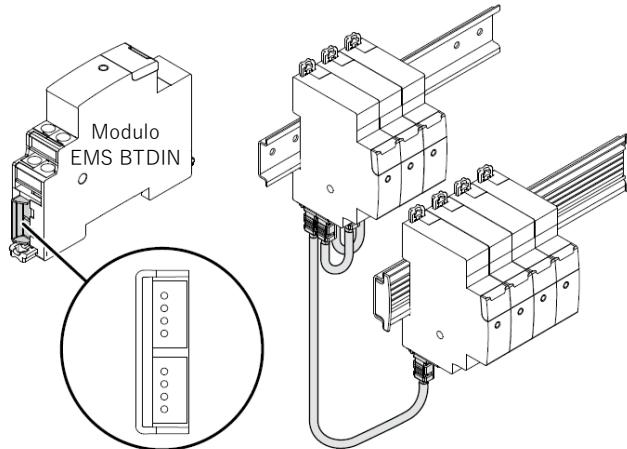
. Adattatore per giunzione cavi precablati:
